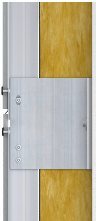
Profilstoss verdeckt mit Kombinationsverbindung an einem Wandhalter
