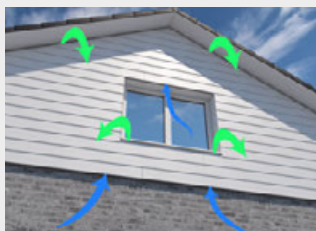
grün: Abluft blau: Zuluft
