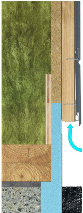
Eine korrekte Hinterlüftung der Konstruktion muss gewährleistet sein
